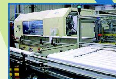
7) Tratamiento de los residuos de papel-cartón, a través de diversos procesos físicos y químicos, para la obtención de compuestos celulósicos aptos para la fabricación de nuevo papel y cartón.
