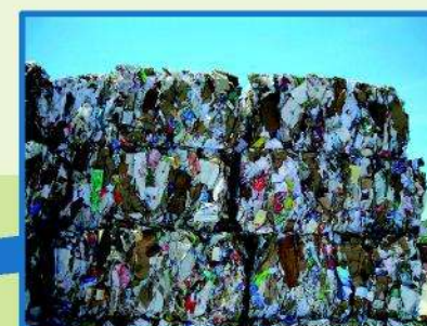
5) Acondicionamiento y prensado en balas de hasta 1.500 kgs. de peso.
